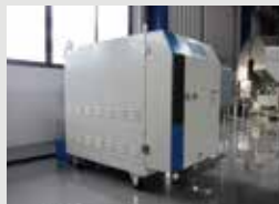
過熱蒸気発生装置 (700°C)
