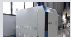
05: 過熱蒸気発生装置
