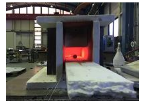
写真上:中央に黒く丸く見えるものが今回のワーク(丸棒)です 写真左:ラジアントカップバーナー
