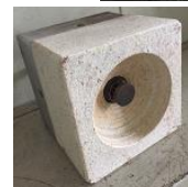
写真上:中央に黒く丸く見えるものが今回のワーク(丸棒)です 写真左:ラジアントカップバーナー
