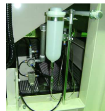
↑コンベアチェーンに滴下式自動給油
